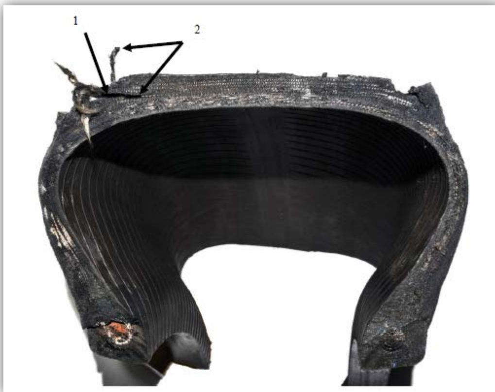
Фото 3. Радиальный срез авиашины. Отслоение 3-х верхних слоев брекерного пояса от 2-х нижних в плечевой зоне протектора со стороны внутреннего борта (1); отслоение и разрыв нитей 2-го нижнего слоя брекера от нитей 1-го нижнего слоя брекерного пояса (2)
