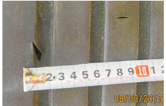
Фото 2. Повреждения авиационной шины колеса левой опоры шасси самолета Б-777-300 08.03.2017
