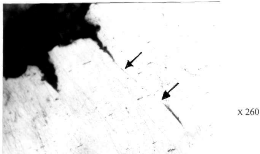
Рис.1.11. Вид в шлифе выявленной при исследовании трещины (указана стрелками) в не разрушенной части ремонтного бужа, стартующей от основания коррозионного повреждения материала.
