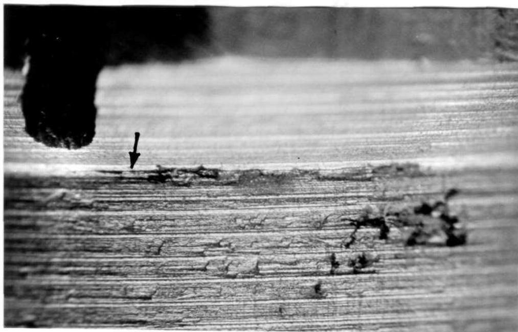
Рис.1.5. Трещина (указана стрелкой) в зоне перехода от посадочной поверхности \varnothing 26X4 к поверхности кругляка \varnothing 30 мм на не разрушенной в эксплуатации части ремонтного буца.
